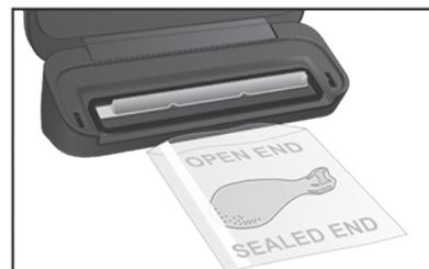
バッグを密封用ヒーターにのせる
